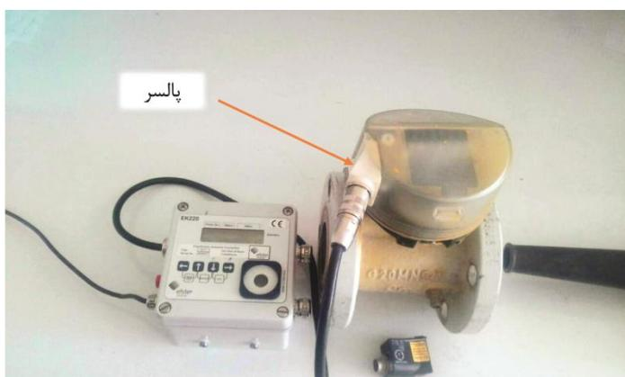
تست آزمایشگاهی پالسر (از سمت راست به ترتیب: دستگاه دمنده باد، کنتور گاز توربینی، پالسر و تصحیح کننده)
