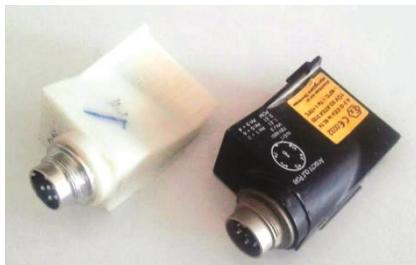
دستگاه پالسر کنتور گاز (سمت راست نمونه خارجی و سمت چپ نمونه ساخته شده در داخل)
